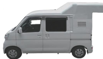
軽乗用車をベースに路面性状測定システムを搭載
