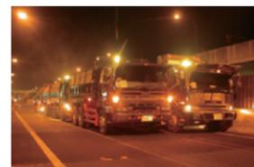
橋梁など構造物の耐荷性能を評価することを目的に、ダンプトラックや大型のクレーン車などを载荷して構造物の挙動や安全性を確認する実験です。
