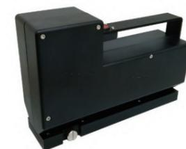
溶射皮膜の品質は、前処理のプラスト施工の品質に大きく影響を受けます。当社では、プラスト施工後の鋼素地面の品質を検査するレーザー散乱光表面粗さ計を開発しています。
