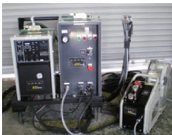
腐食環境が厳しい鋼桁端部や飛来塩分の多い沿岸地域の鋼構造物には、特に耐食性の高い皮膜が求められます。また、すでに腐食損傷が発生している部位には防食性能の回復が必要です。当社では、鋼構造物の防食対策・補修技術として、金属溶射システムの開発を行っています。この溶射機は、特に塩害環境下で耐食性が高い Al-(5%)Mg 合金を溶射材料に用い、熱源は高品質な皮膜が得られるプラズマアークを使用しています。私たちは、溶射ガンを狭隙部でも施工可能なように小型化した溶射機 TAPS® (Transfer Arc Plasma Spraying) を開発し実用しています。
