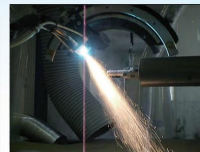
溶射高力ボルトの施工状況
