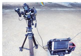
舗装面、橋梁コンクリート面、トンネル覆工面などの高精細画像を効率よく撮影するシステムを開発しています。路面性状計測車は、舗装面高解像度画像（1mm/pix）・わだち掘れ（100mmピッチの道路横断プロファイル）・IRI（乗り心地係数）を時速100kmで走行しながら収録します。
