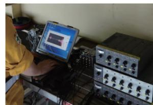
各種計測器を用いて構造物の変位・応力・振動などの挙動や周辺地盤上における騒音や振動などの環境レベルを定量的に測定します。
