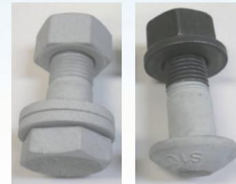
Al-(5%)Mg 溶射高力ボルトの外観
