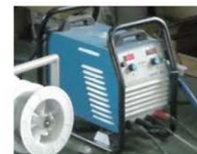
現場施工用アーク溶射機
